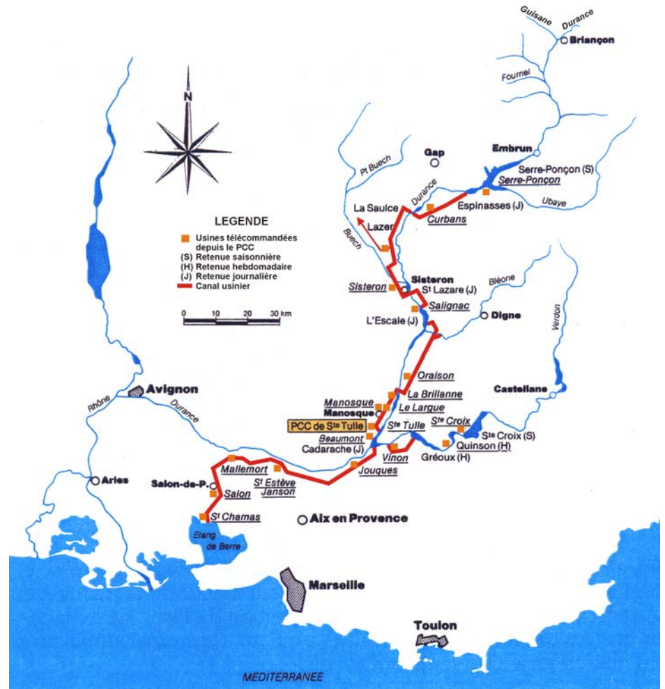
Parcours de la Durance, qui se jette dans le Rhône à Avignon, et de son aménagement hydroélectrique : canal usinier EDF, en rouge, de Serre-Ponçon à l'Etang de Berre (via l'usine hydroélectrique de Saint-Chamas) ; usines hydroélectriques en jaune.
