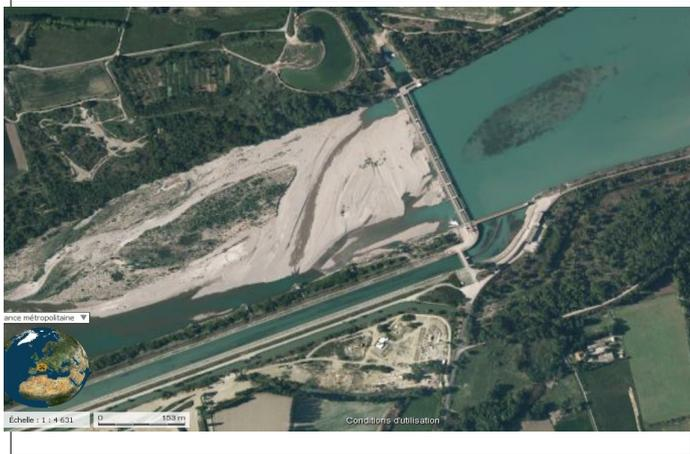
Le barrage de Mallemort a été construit pour récupérer dans le lit de la Durance, l'eau turbinée à Jouques, et l'envoyer sur Salon et Saint-Chamas, par le canal usinier qu'on voit en bas de la photo.
